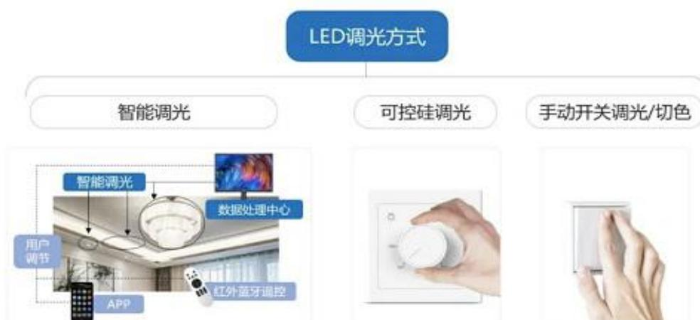
可控硅调光是采用可控硅切角技术进行调光的，属于机械调光的一种，这种调光方式可追溯至白炽灯时代，是 LED 灯最早采用的调光
