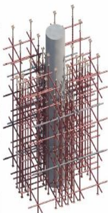
梁柱节点抱柱加固措施
