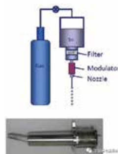
图3 锡液滴发生器的示意图(顶部)和照片(底部)
