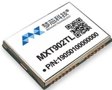
MXT902TL 精密授时模块，是梦芯科技专门针对授时市场推出的一款专业授时模块，该模块基于企业完全自主知识产权的导航定位芯片设计，输出的 PPS 可以达到稳定的纳秒级精度，具有高可靠性，为通信基站授时、电力时间同步、金融网络时间同步等应用提供完美的解决方案。
