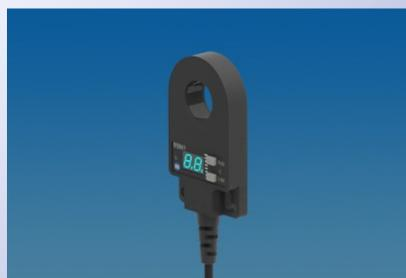
IMS 环型电感传感器专用于金属物料检测,多种孔径适应不同检测物大小,数字显示感测强度,可视化的灵敏度调节功能。
