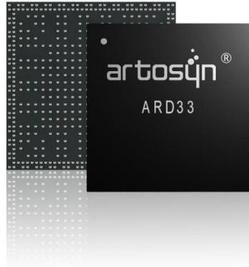
ARD33 SoC 针对无人机、扫地机器人、玩具机器人、深度相机等机器人领域设计，集成 4 核 A53 CPU、3.2Tops 算力、XM6 DSP 等算力，并提供双目深度提取等算法资源支持，具备 8MP@30fps ISP 处理和 H.264/265 编解码能力。
