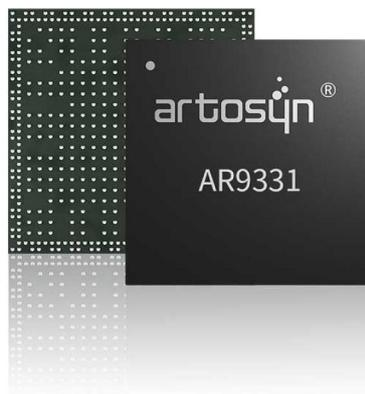
AR9331 SoC 针对中高端专业安防、泛安防、汽车电子、消费电子等领域设计，集成 4 核 A53 CPU、3.2Tops INT8 NPU 的强大算力。同时集成安防级图像处理器，具备 8MP @30fps 的 ISP 处理和 H.264/265 编码能力。
