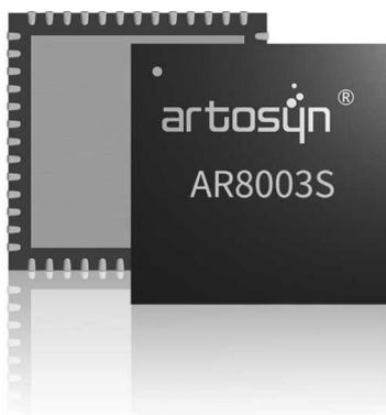
AR8003s 是一款高度集成射频收发器芯片, 适用于 2.3GHz ~ 2.7GHz 和 4.9GHz ~ 5.9GHz 频段的 MIMO 应用; 包含四个发射器和接收器, 同时集成了片上 PA; 具有业界领先的射频性能和优异的一致性。
