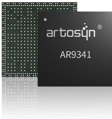
AR9341 SoC 针对高端专业安防、智慧交通、泛安防、机器人、消费电子等领域设计，集成 4 核 A53 CPU、XM6 DSP、4Tops INT8 NPU 的强大算力。同时集成安防级图像处理器，具备 9MP @60fps 的 ISP 处理和 H.264/265 编码能力。
