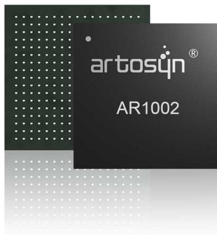
AR1002 是一款高集成度单频 2.4G 2\*2 MIMO 无线视频收发芯片，内置 H.264 编码器、SDRAM、双核 Cortex-M7、无线基带以及 2.4G RF 射频收发器，主要应用于低成本无人机领域以及无线图像传输领域。
