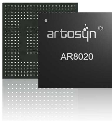
AR8020 是一款高集成度 2\*2 MIMO 无线视频收发 SoC 芯片，内置的 H.264 编码器、SDRAM、双核 Cortex-M7 以及无线基带。
