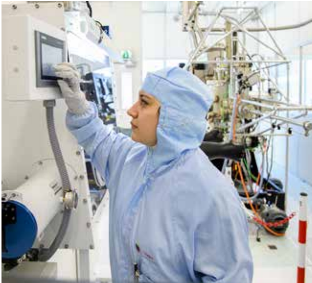
共有第一作者Elham Fadaly 正在操作金属有机气相外延(MOVPE) 这台机器用来生长六角形硅锗壳的纳米线
