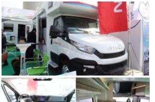
2018 款飞神房车采用进口依维柯 NEW DAILY 底盘改装的自行式 C 型房车,它的空气悬挂和 ESP 车身稳定系统在同级别国产房车中并不常见;车身采用一体化玻璃钢成型的技术,整体框架采用铝合金骨架、三明治复合板。
