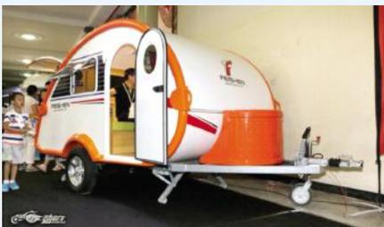
整车长 4357 毫米, 宽 2153 毫米, 高 2050 毫米。所以很多家用轿车都能够胜任拖车的工作。
