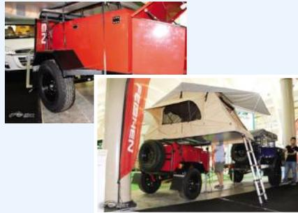
轮胎配备的是 265/75R16 的 MT 轮胎, 整备质量为 500 公斤。悬挂方面和其他拖车不同, 并没有采用扭力梁或者整体桥式悬挂, 选用独立悬挂, 对于越野路面, 能够更好的吸收震动。制动系统为机械制动配合盘式制动器, 在前车制动的时候, 拖车能够提供辅助制动力。60 升不锈钢水箱保障了野外用水的一切需求, 不论是洗漱, 还是做饭, 两三天行程的露营, 足够用了。储物空间虽然比不上水滴房车, 但是也是很充足的, 钢筋铁骨里面, 可以放上足够多的装备了。
