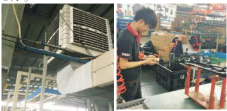
各流水线加装气阀开关,下班关闭 新购固定扭力工具
